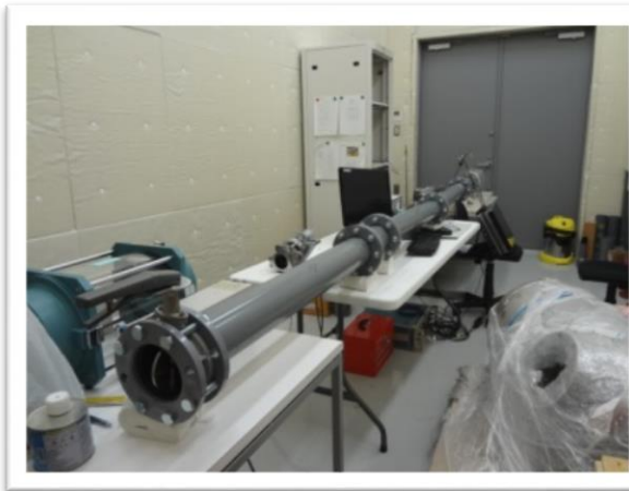
<ターボ過給システム実験室> システムの流動特性を解明するとともに 数値シミュレーションモデルの検証に活用
