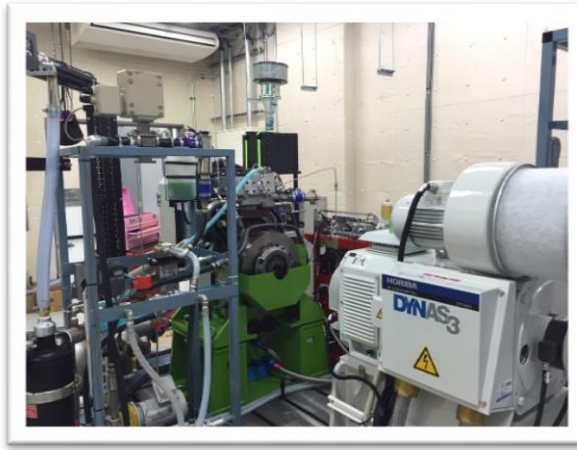
<単気筒エンジンシステム実験室> 各種設計・運転条件での実験と開発し た各サブモデル，ターボ過給，燃料改質， 熱電素子の効果の検証に活用
