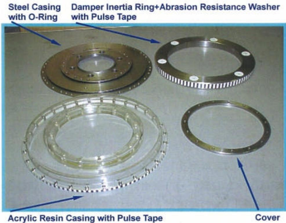
図 (a) 2点同時測定用粘性ダンパを構成している主用部品
