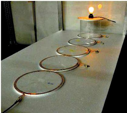
図1 中継コイルの電球点灯実験<sup>(9)</sup>
