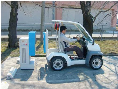
図 3 1 kW クラス磁界共鳴ワイヤレス給電評価 EV<sup>(11)</sup>
