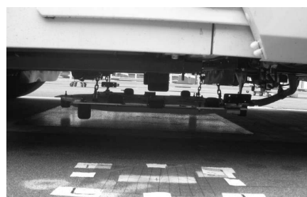
2次コイルを降ろした状況
