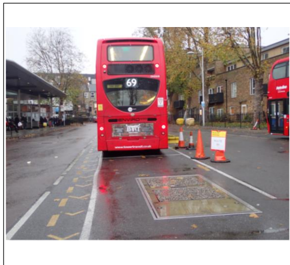
図 WPT 式 2 階建てバスと地上コイル
