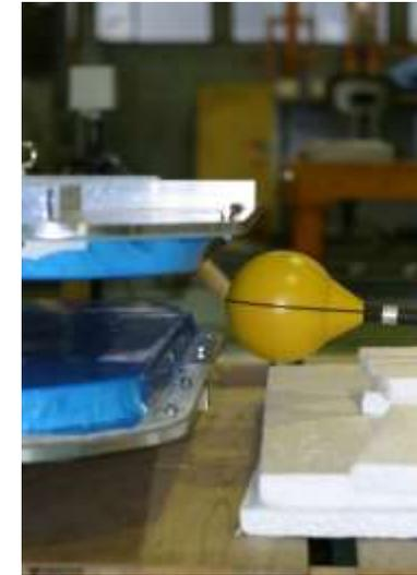
漏洩磁界を計測中のNARDAの3軸式磁界プローブ
