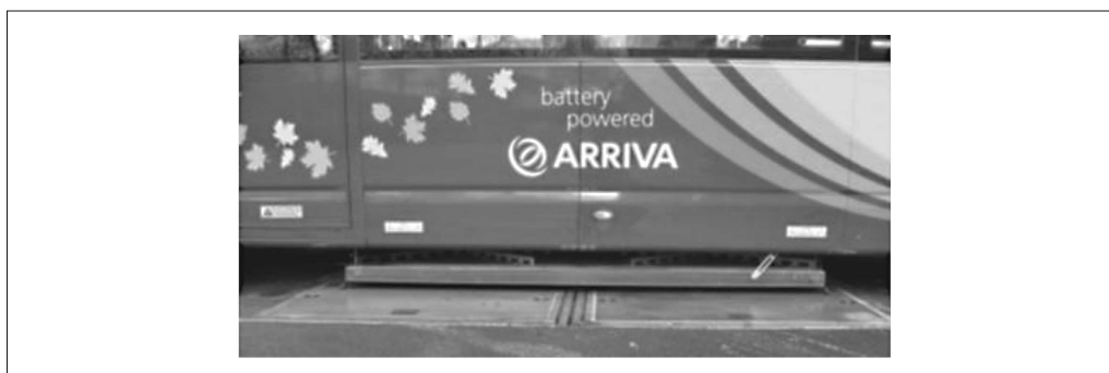
〔図 11.19〕 2次コイルを地上コイル上に降ろしての充電状況
