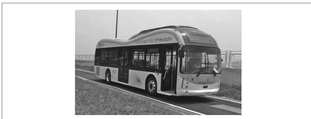
〔図 11.21〕 Gumi 市での走行中給電バス
