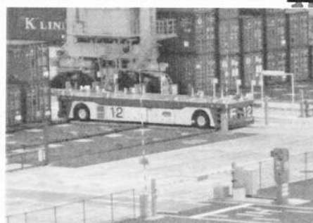
コンテナヤードでのAGV
