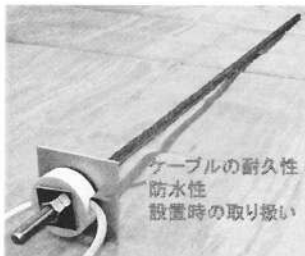
東横エルメスのロックボルト軸力計
