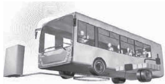
図3 Wampfler 社製の電磁誘導式充電システム
