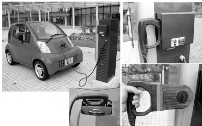
図3 Magne Charge による充電の状況
