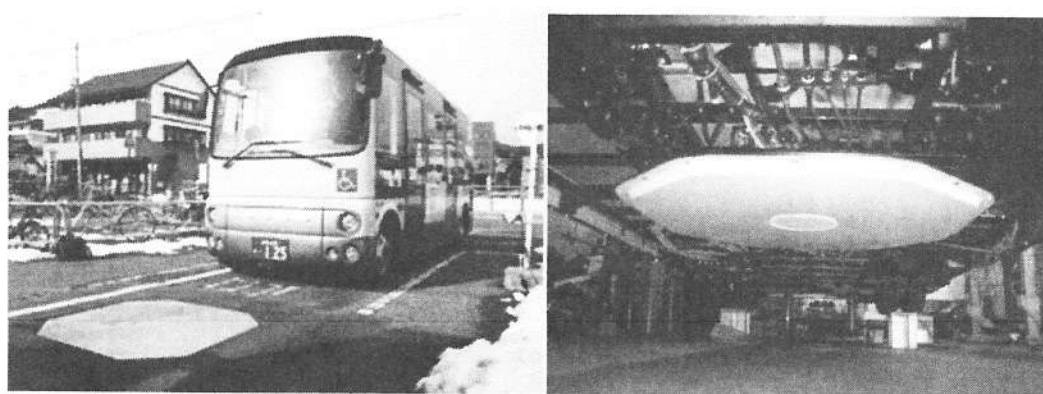
図12 WEB-4の1次コイルと2次コイルの設置
