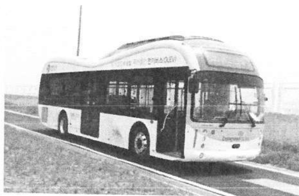
a) 走行中給電バスと地上コイル
