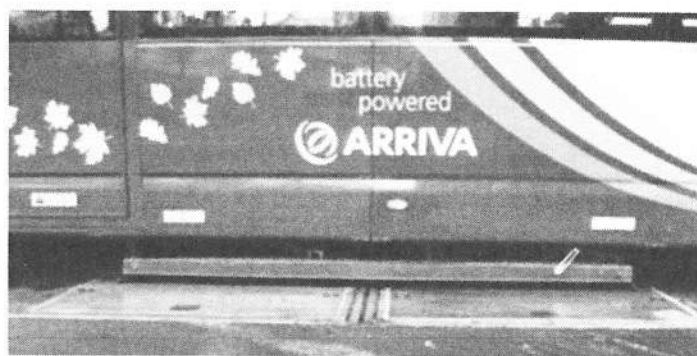
図11 2次コイル昇降式 IPT システム
