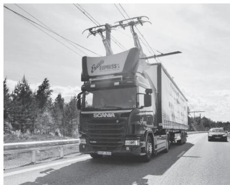
図3 Scaniaの接触式走行中給電
