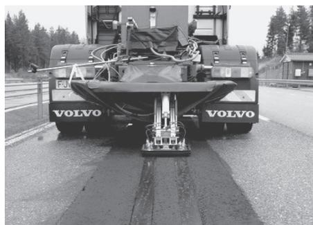
図2 VolvoのSlide Inシステム
