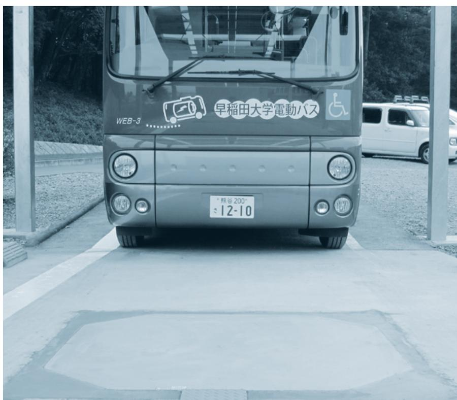
昭和飛行機工業では、電気自動車 (EV) や電動バスなどに向けた大容量の電力を供給するワイヤレス給電システムの開発に取り組んでいる。現在、バスを中心に進んでいるワイヤレス給電システムの取り組みをはじめ、走行中給電を可能にするワイヤレス給電システムについて解説する。 (本誌)
