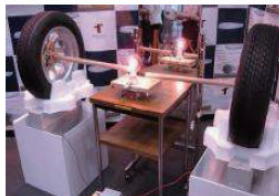
豊橋技術科学大学(WTP2012) (出力 50~80Wギャップ 10cm以上)
