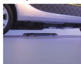
三菱自動車 iMiEV用磁界共鳴式(Gap180mm、水平方向位置ずれ±200mmで85%の出力)
