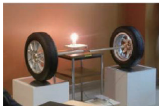
自動車タイヤ50W電力伝送実験
