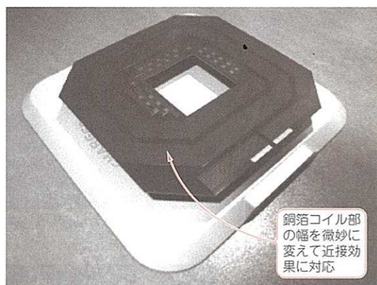
写真6 金属薄膜で形成したEV用コイル プリント基板コイルでも3kWの電力伝送ができる
