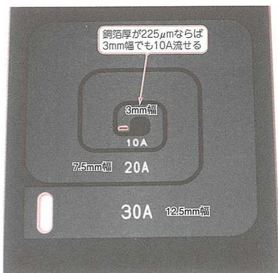
写真7 厚銅基板の電流と線幅 3mm幅のプリント基板コイルでも10A流せる
