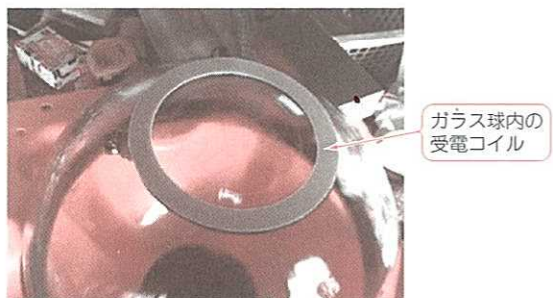
写真11 江戸っ子1号の送受電コイル 耐圧性を損わずにガラス球の内外面で給電できる
