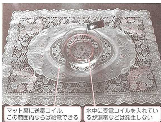
写真5 テーブル・マットを通して水中給電 テーブルにコイルを埋め込まなくてもLEDの水中花を作れる
