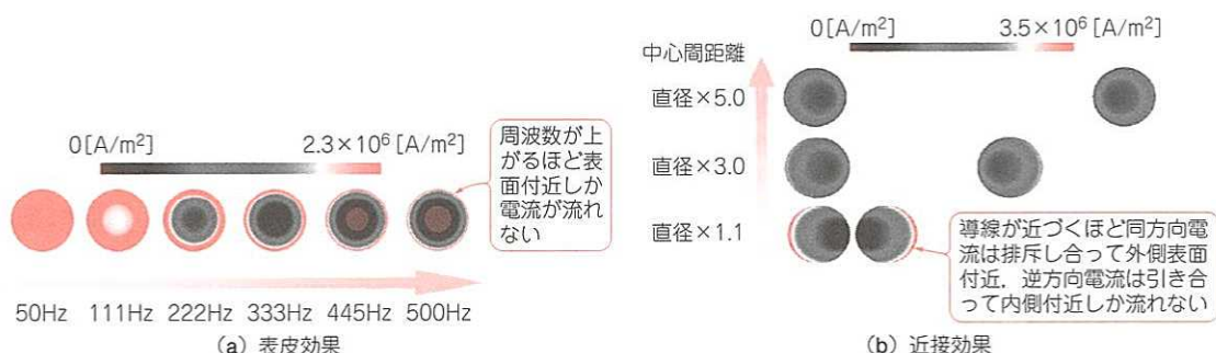
図A 導体断面における表皮効果と近接効果(電流密度分布) 表皮効果は周波数が高いほど、近接効果は導線間距離が狭いほど現れる
