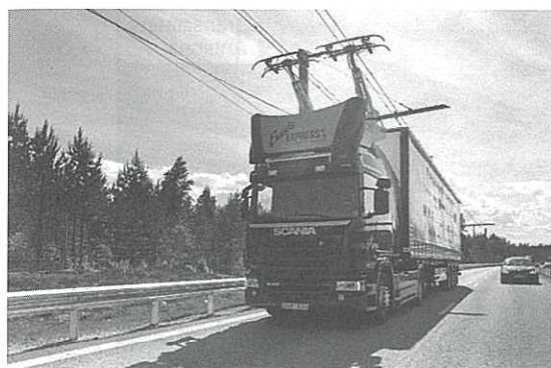
写真12 Scaniaの接触式走行中給電 (20) トロリーバスよりいかめしいパンタグラフ・トラック
