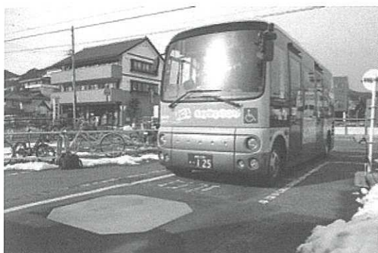
写真6 長野市のワイヤレス給電コイルとWEB-4 地面に埋め込まれたコイルに向かう緑ナンバーのWEB-4
