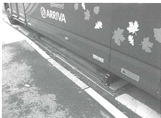
写真4 IPT Technologyのワイヤレス給電システム 昇降装置で送電コイル上に受電コイルが降りて充電する
