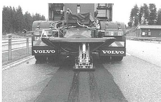
写真13 ボルボ社のSlide Inシステム (21) 雨の日に他の車や二輪車が電極上でスリップするかも
