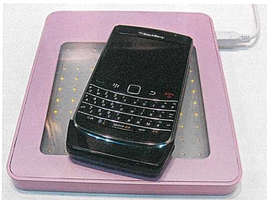
〈写真13〉 透明電極を採用し5Wまで給電可能な電界結合方式のワイヤレス充電器の試作機 [株式会社製作所]
