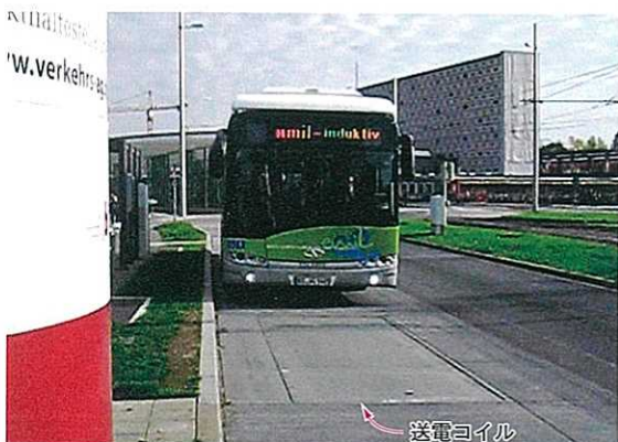
〈写真11〉 Bombardier社の200 kWワイヤレス給電システムに対応した電動バス(ドイツのBraunschweig中央駅)
