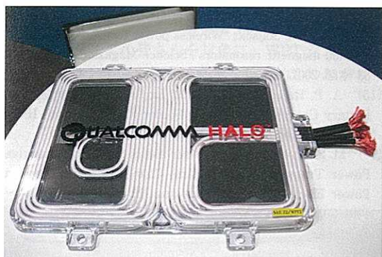
〈写真10〉 Qualcomm HALOのD-Dコイル
