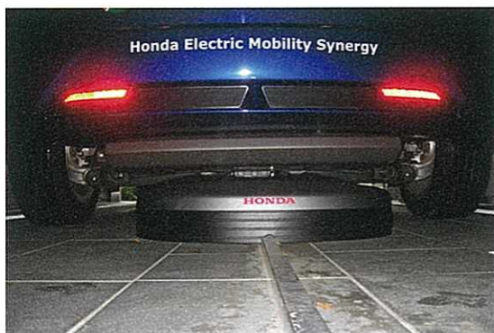
〈写真9〉ホンダ「フィットEV」に対応したワイヤレス給電システム〔㈱IHI, Witricity, 本田技研工業㈱〕
