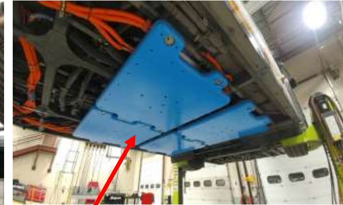
車上コイルの設置状況 50kWコイル × 4
