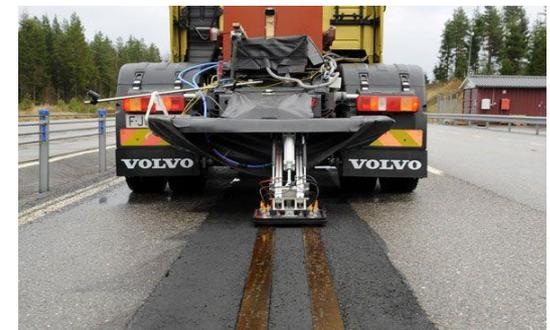
Volvoの接触式走行中給電トラック
