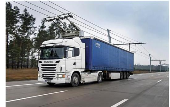
Siemens/Scaniaの接触式走行中給電トラック
