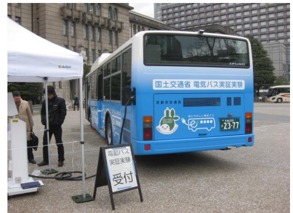
三菱重工バス 電池バンク切替急速充電 50kW バス充電所(1か所)
