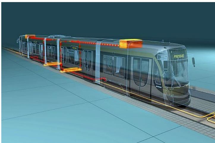
電磁誘導式非接触給電システムのPRIMOVE技術と、
