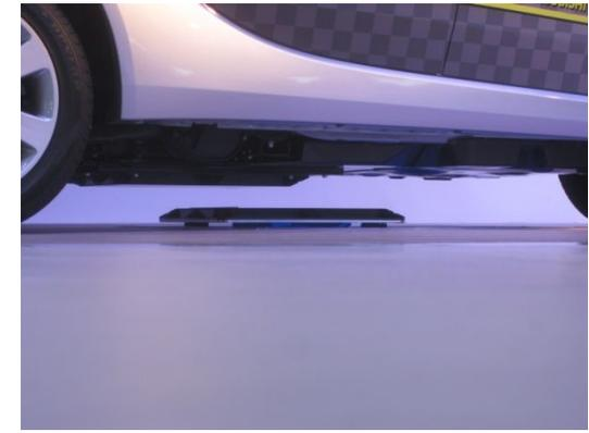
三菱自動車 iMiEV用磁界共鳴式 (Gap180mm、水平方向位置ずれ $\pm 200$ mmで85%の出力)
