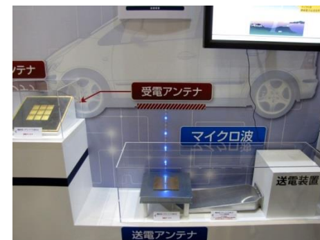
三菱重工業(人と車のテクノロジー展2013) 出力1kW、効率68%
