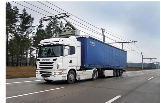
Siemens/Scaniaの接触式走行中給電トラック
