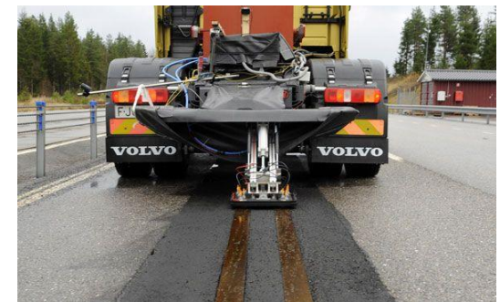
Volvoの接触式走行中給電トラック
