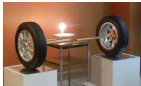
自動車タイヤ50W 電力伝送実験
