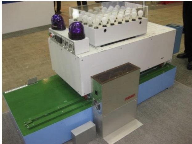
AGV用1kW、10kHz型(TPH)
